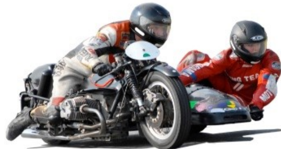
Basset : Grandes roues en 16" ou "Kneeler" car le pilote conduit à genoux
